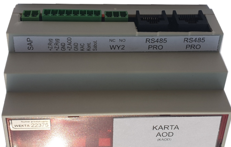
KARTA AOD MONTOWANA W SZAFIE SKD WIDOK OBU STRON PRZYŁĄCZY
